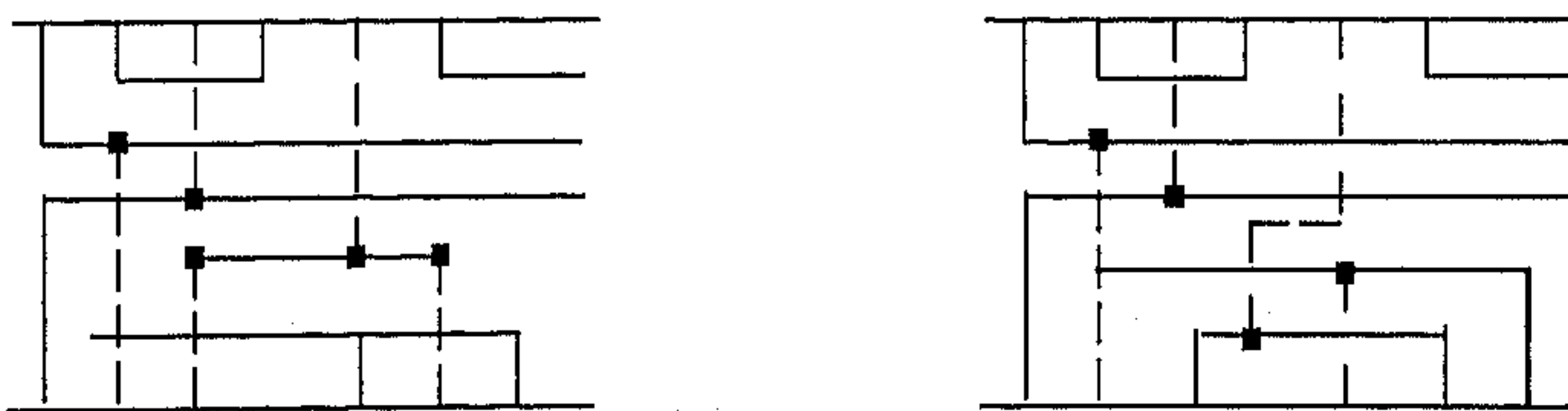
Fig. 4.8 : Shifting of vias
